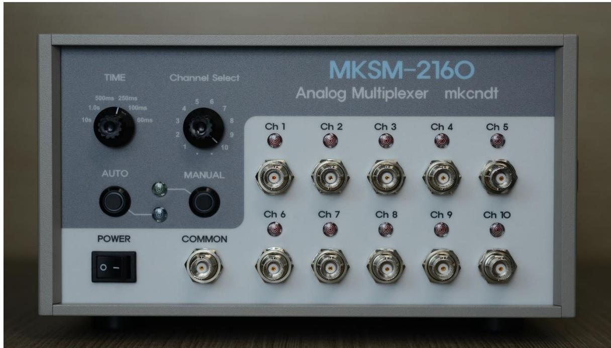
엠케이씨에서 개발한 MKSM-2160은 Solid State를 이용한 1 - 10채널 멀티플렉서입니다. 외부에서 받은 신호를 다채널로 변환하는데 있어 원하는 채널수와 인터벌 시간을 세팅할 수 있으며 신호를 받고자 하는 채널 하나만을 선택하는데 있어 자동에서 매뉴얼 모드로 변환하여 사용할 수도 있습니다.
