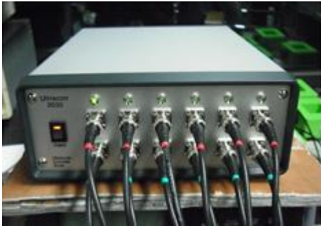
UC-170과 MUX, 콘테이너를 사용하여 모르타르를 시간 축 상에서 분석
