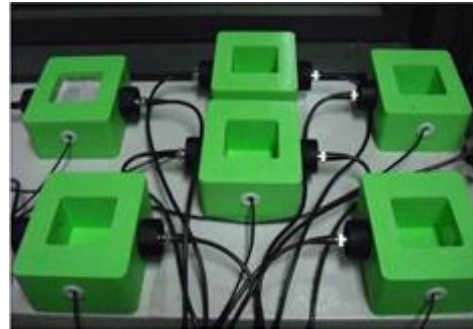
UC-170과 MUX, 콘테이너를 사용하여 모르타르를 시간 축 상에서 분석
