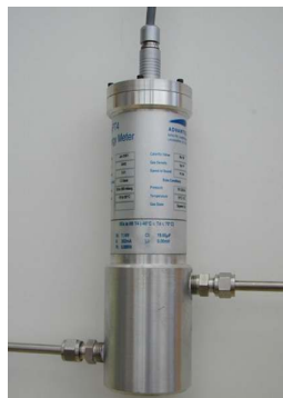
<영국 GL Noble Denton사의 발열량측정기 모델 GasPT와 발열량 측정결과>
